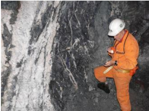
Fahlerzreicher Schwerspatgang in der Grube Clara
