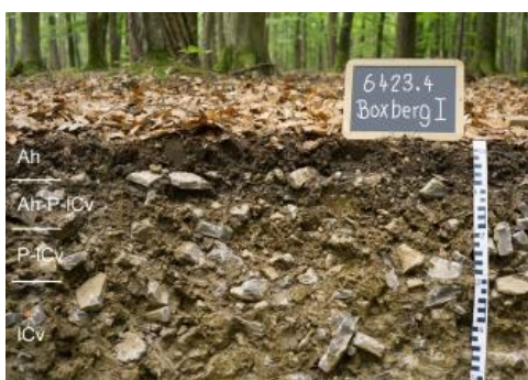
Pelosol-Rendzina aus tonreicher Fließerde aus Verwitterungsmaterial des Oberen Muschelkalks (Kalkstein, Tonmergelstein) (i24)
