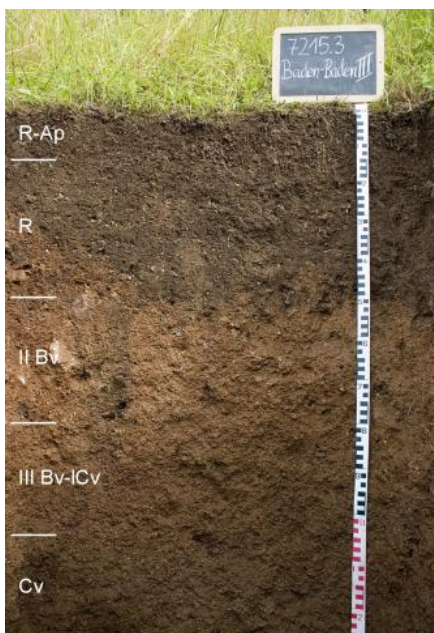
Mäßig tiefer Braunerde-Rigosol aus oberflächennah umgelagerter Granit-Fließerde auf Granitzersatz (a201)
