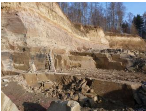
Beispiel für eine sedimentäre Werksteinlagerstätte: Schilfsandstein
