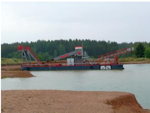
Bei Hüfingen werden im Nassabbau mit dem Schwimmbagger Kiese für den Verkehrswegebau gewonnen
