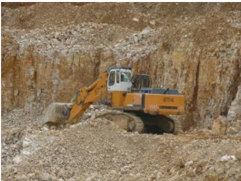
Abbau von Bankkalkstein aus dem Oberjura
