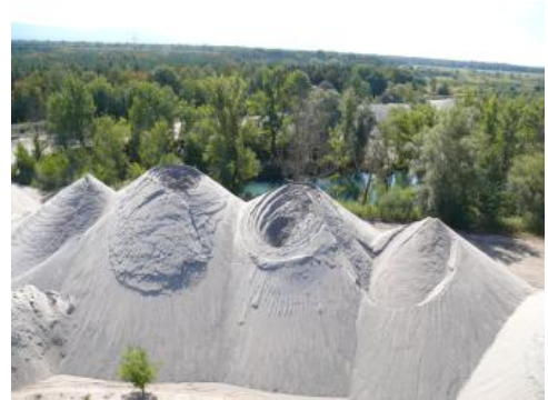
Aus den quartären Kieslagern des Oberrheingrabens durch Aufbereitung abgetrennte Fein- bis Grobsande.
