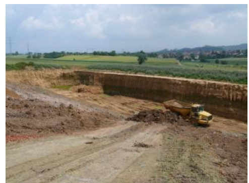
Abbau von Löss und Lösslehm
