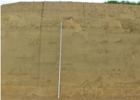
Lösslehm ist ein hellgelber bis mittelbrauner, toniger bis stark toniger und schwach feinsandiger Schluff
