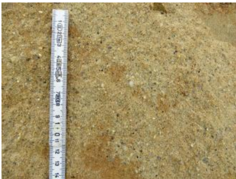
Detailaufnahme von schwach feinkiesigem Mittel- bis Grobsand der Grimmelfinger Graupensande
