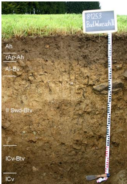
Tief entwickelte pseudovergleyte Parabraunerde- Braunerde aus lösslehmhaltiger Fließerde über rißzeitlichem Geschiebemergel
