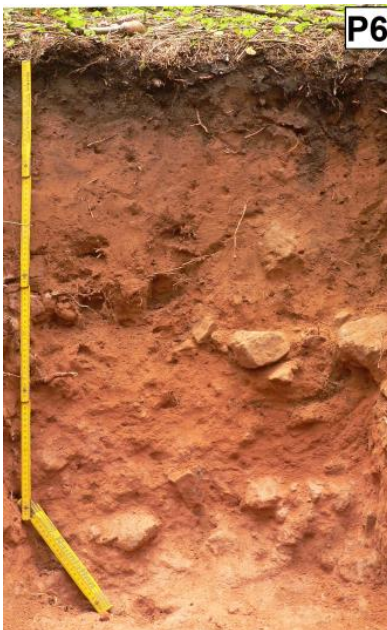
Podsol-Braunerde aus einer steinarmen Fließerde über Schutt und Zersatz des Unteren Buntsandsteins (D17)
