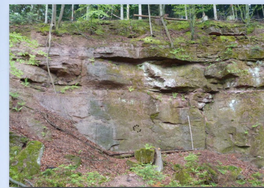
◀ Abb. 9: Die freigestellte alte Abbaumwand mit Probebohrlöchern. Die eigentliche Werksteinzone beginnt am oberen Ende der Messlatte (Länge: 3 m) [vergleiche Profil der Abb. 6].
