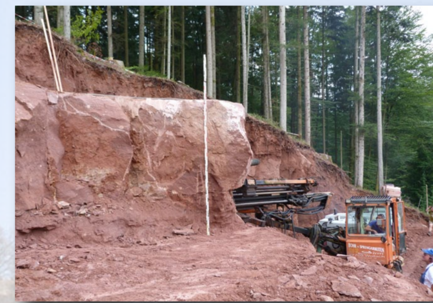
◀ Abb. 10: Oberste Sandsteinbänke der Abraumschicht nach der Freilegung im August 2012; im Hintergrund ein Bohrergerät beim Bohren horizontaler Löcher für die Seilsäge. Die geröllreichen Sandsteinbänke sind für den Garten- und Landschaftsbau gut geeignet.
