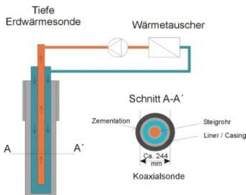
Schematische Darstellung einer koaxialen Erdwärmesonde (GeoMol LCA-Projektteam, 2015a)
