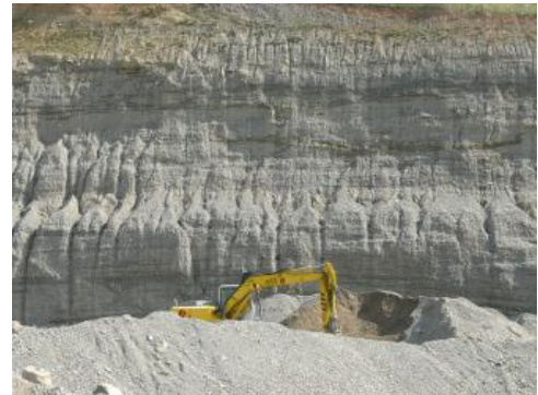
Gewinnung im Trockenabbau in der Kiesgrube Schaffhausen
