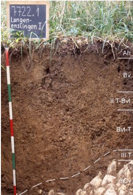
Mäßig tief entwickelte lessivierte Terra fusca-Braunerde aus lösslehmreichen Fließerden über Kalkstein des Oberjuras (Oberer Massenkalk) auf der Flächenalb nördlich von Langenenslingen (q35)
