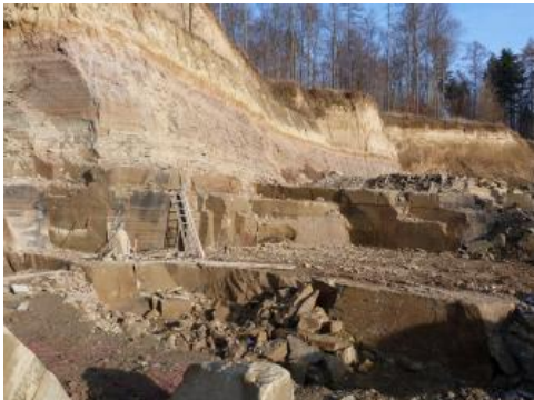
Beispiel für eine sedimentäre Werksteinlagerstätte: Schilfsandstein
