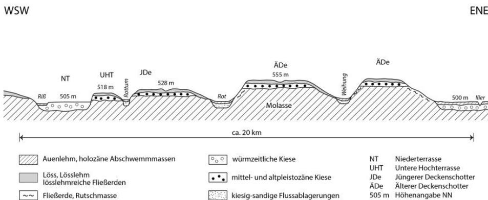
Schematischer Schnitt durch die nördlichen Iller-Riß-Platten (Kösel, 2016)
