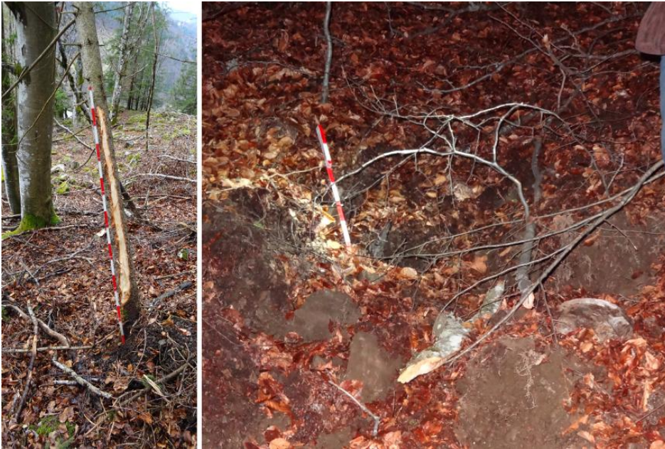
Schlagmarken des Sturzblockes im Hang
