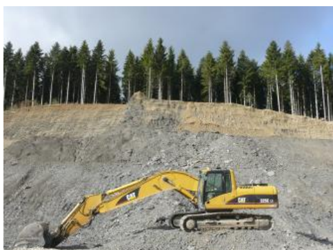
Gewinnung von Opalinuston aus dem Mittleren Jura in der Tongrube Schömberg / Withau
