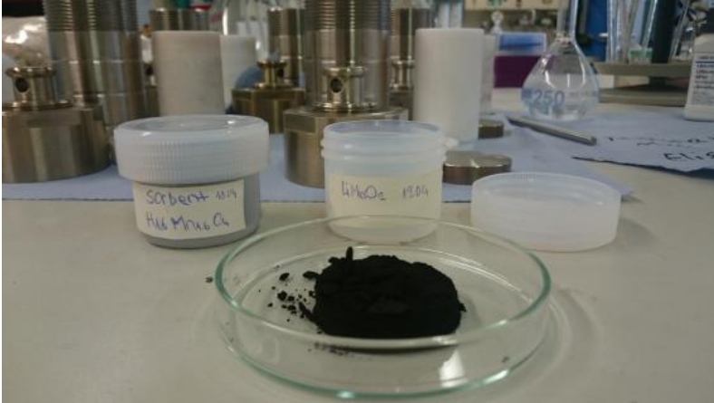
Laborversuche zur Gewinnung von Lithium mittels Adsorptionsverfahren. (Quelle: Energie Baden-Württemberg AG)
