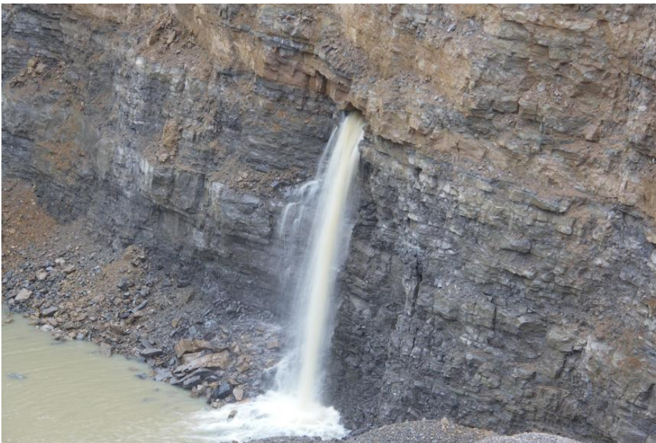
Oberer Muschelkalk (Steinbruch Blaufelden-Gammesfeld südwestlich von Rothenburg o. d. Tauber.) – Grundwasseraustritt nach einem Starkregenereignis aus einem Lösungshohlraum an der Steinbruchwand.
