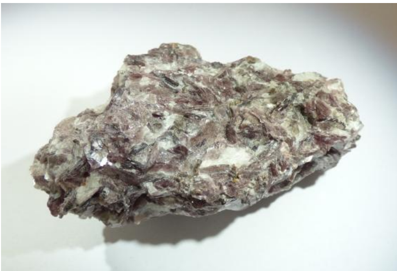
Rosafarbener Li-Glimmer (Lepidolit) in einem Pegmatit aus Norwegen. Lepidolit ist, neben Spodumen und Petalit, ein wichtiges Erzmineral des Lithiums aus Festgestein.
