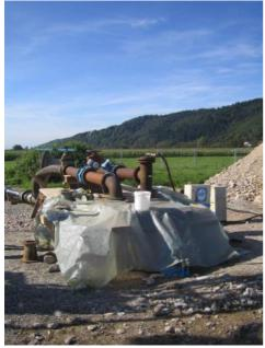
Versuchsaufbau während eines Pumpversuchs zur Bestimmung von Aquiferkennwerten
