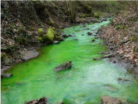
Mit dem Markierungsstoff Uranin eingefärbtes Oberflächengewässer
