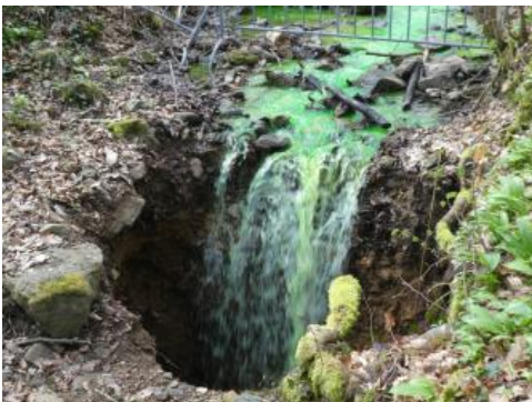
Übertritt des mit Uranin markierten Wassers in einen Erdfall
