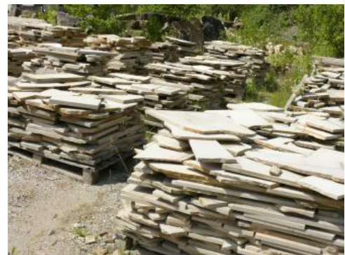
Gesägte Gesteinsplatten der Sandsteine aus der Exter-Formation.
