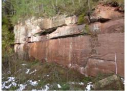
Abbauwand des Steinbruch Loßburg (RG 7516-129) mit mächtigen Werksteinbänken.
