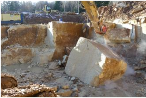
Werksteinbank des Stubensandsteins
