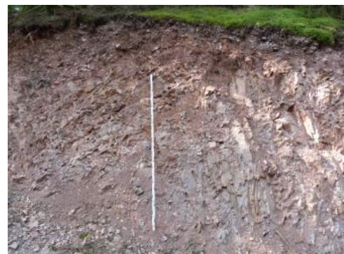
Durch oberflächennahe Prozesse zerstückelter, z. T. vergrusender Kienbach-Granit
