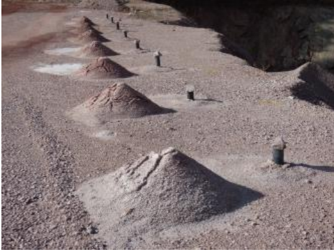
Vorbereitung von Sprengbohrlöchern entlang der Abbaukante im Steinbruch Tennenbronn (RG 7816-1)
