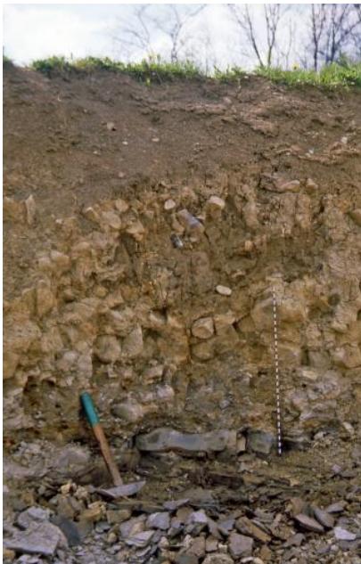
Inhomogenes Verwitterungsprofil in den Gesteinen der Jurensismergel-Formation
