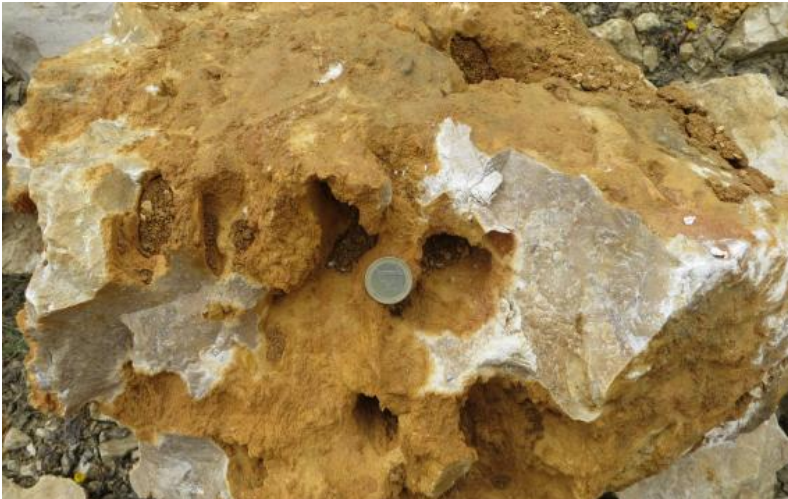
Die Makroporosität des „Zuckerkörnigen Lochfels“ ist diagenetisch entstanden. Die Hohlräume bildeten sich nach der Rekalzitisation von Dolomit und anschließender korrosiver Erweiterung der dabei entstandenen Porosität.
