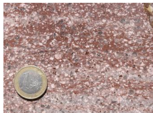
Detailaufnahme des Baden-Baden-Quarzporphyrs, der auch unter dem Namen Leisberg-Porphyr oder Pinit-Porphyr bekannt ist
