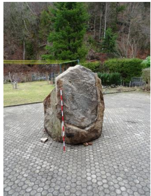
Sturzblock vom 07.03.2019 mit ca. 2,2 m 3 Volumen
