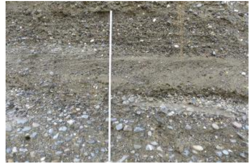
Schräggeschichtete sandige Kiese mit Sandlagen in der Abbauwand der Kiesgrube Ingoldingen
