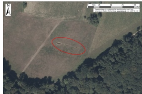
Orthofoto einer Erdfallkette
