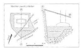
Verlauf der Felskanten und Ausdehnung der Lockerzone in Pfeilerachse 1 (Grafik: Kobler & Schreiner, 1975)
