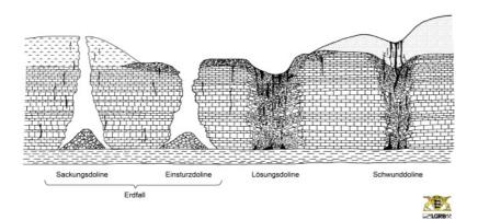
Dolinen- und Erdfalltypen. Je nach Entstehung wird zwischen Lösungsdoline, Schwunddoline, Einsturzdoline oder Sackungsdoline unterschieden.
