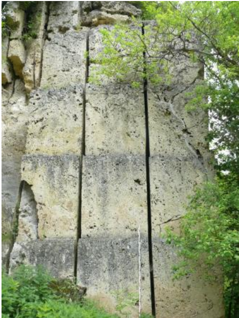
Kalktuffwand mit Abbauspuren durch eine Schrämsäge
