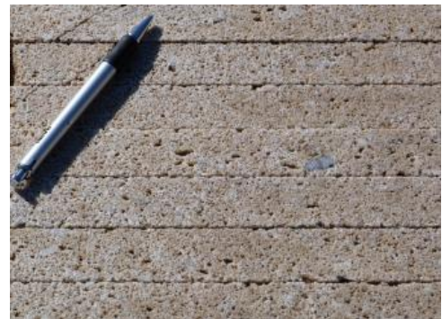
Grobkörniger, stark poröser Pliezhauser Stubensandstein
