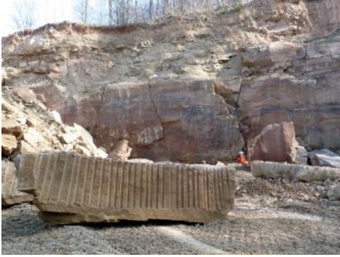
8 m mächtiges Werksteinlager im Steinbruch am Winterhaldenhau bei Heilbronn-Sontheim
