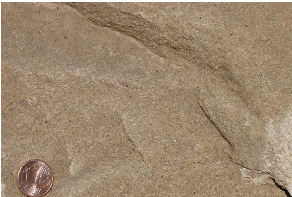
Schilfsandstein aus Niederhofen mit typischer Sprenkelung durch Limonit und Manganoxide
