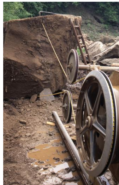
Gewinnung von Niederhofener Sandstein, Zerteilung großer Blöcke durch die Seilsäge
