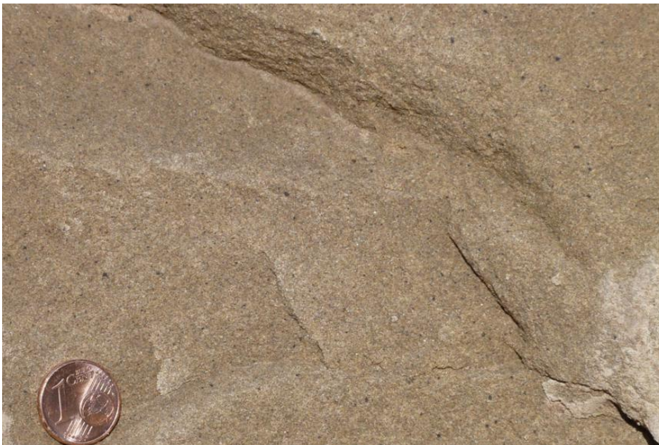
Schilfsandstein aus Niederhofen mit typischer Sprengelung durch Limonit und Manganoxide
