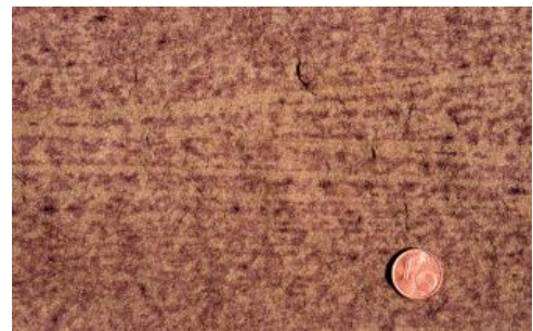
Rot gefleckte Varietät des Weiler Schilfsandsteins
