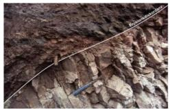
Erosionsdiskordanz in einer Baugrube in Friedenweiler im Eisenbach-Granit
