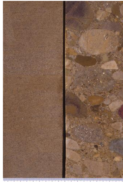
Bohrkerne aus der Erkundungsbohrung am Steinbruch Pfaffenweiler; links Pfaffenweiler Kalksandstein, rechts grobes Tertiärkonglomerat
