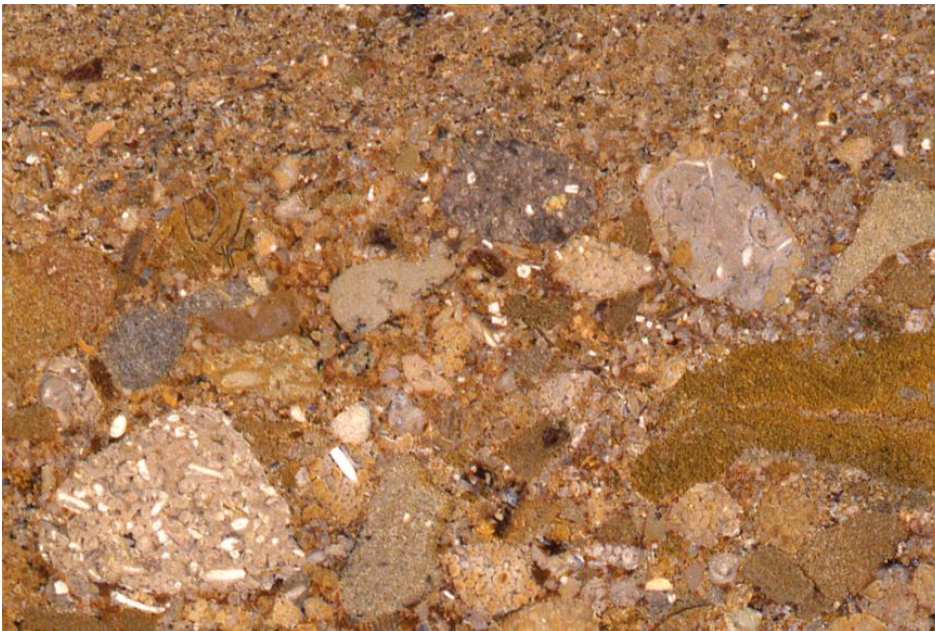
Tertiärkonglomerat bei Pfaffenweiler, Wechsel von Kalkstein-Konglomeraten und mittel- bis grobkörnigen Kalksanden
