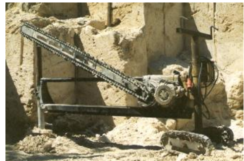
Kalktuffabbau der Fa. Beck bei Bärenthal: Schrämsäge zum Kalktuffabbau
