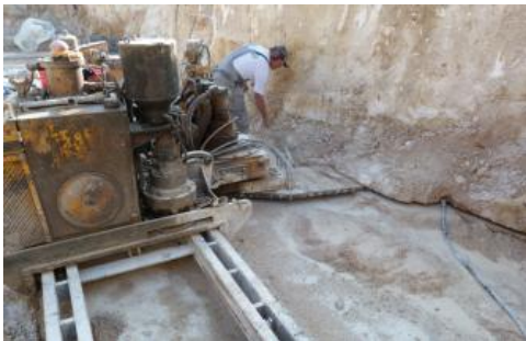
Abbau mit Schrämsäge, Steinbruch Gauingen
