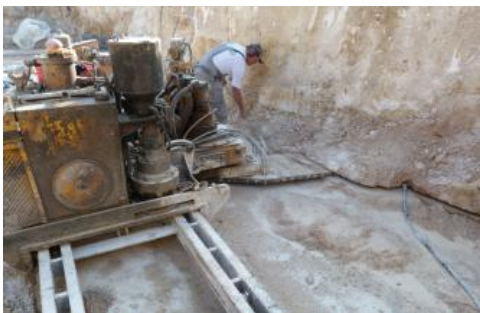
Abbau mit Schrämsäge, Steinbruch Gauingen
