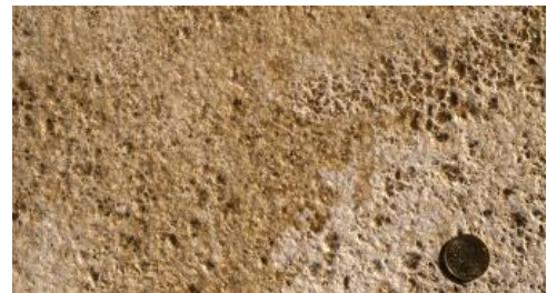
Fassadenplatte mit sandgestrahlter Oberfläche (Cannstatter Travertin)
