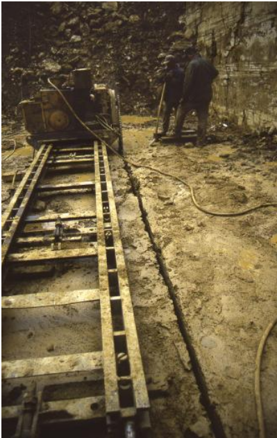
Abbau mit der Schwertsäge im Travertinsteinbruch Lauster
