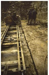
Abbau mit der Schwertsäge im Travertinsteinbruch Lauster
