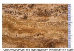
kavernösem und dichtem Sinterkalk
