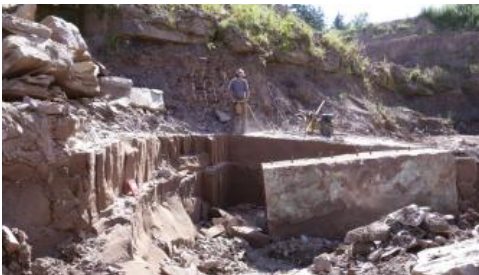
Abbau der roten Plattensandsteine im Steinbruch Vierhäuser
