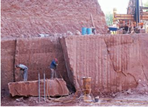
Sandsteingewinnung im Steinbruch Dietenhan
