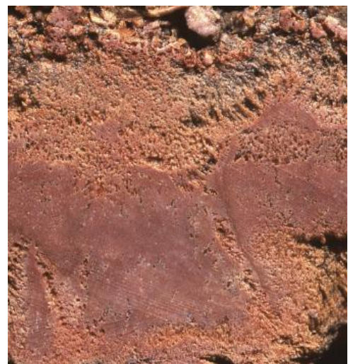
Böttinger Wallmarmor mit charakteristischer Färbung und typisch wechselnder Porosität
