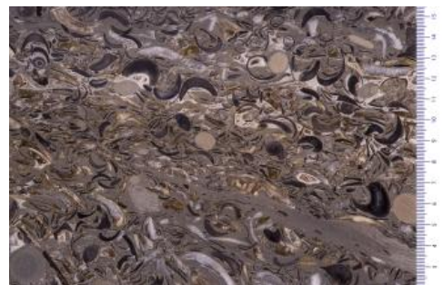
Schnitt senkrecht zur Schichtung durch einen Arietenkalksteinblock
