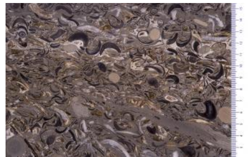
Schnitt senkrecht zur Schichtung durch einen Arietenkalksteinblock
