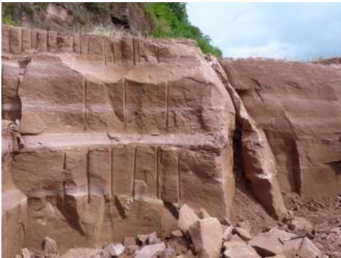
Steinbruch zur Gewinnung von Werksteinblöcken (Hartsandstein)
