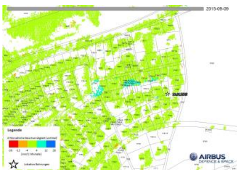
Räumliche Verteilung der Hebungsgeschwindigkeiten im Hebungsbereich „Nord“ am 09.09.2015
