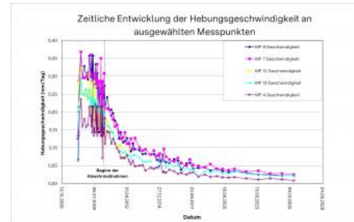
Zeitliche Entwicklung der Hebungsgeschwindigkeit an ausgewählten Messpunkten [mm/Tag]
