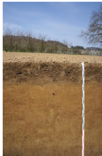
Holozänen Abschwemmmassen, bestehend aus tonigen Schluffen
