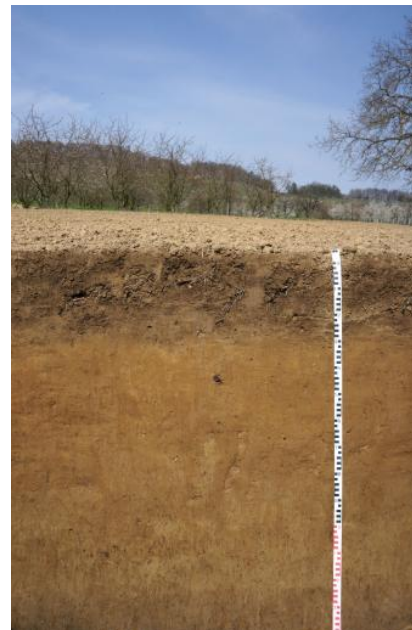
Holozänen Abschwemmmassen, bestehend aus tonigen Schluffen
