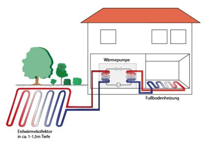
Schematische Darstellung eines Heizsystems mit einem Flächenkollektor
