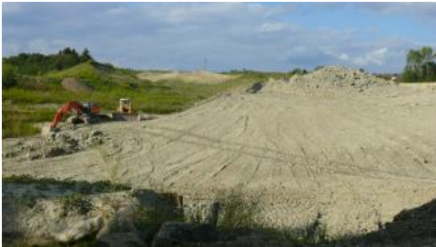
Abbau in einer Tongrube mittels Planierraupe und Löffelbagger
